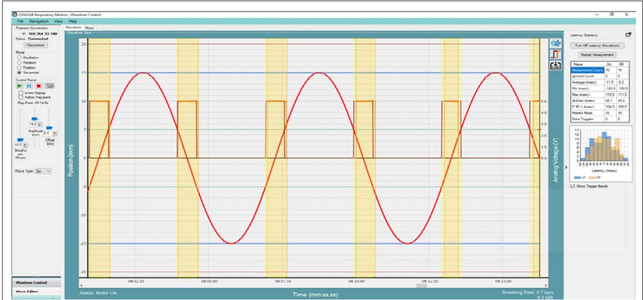
Şekil 26. Fantom tetikleme sinyali (kahverengi) ve BGC cihazından gelen elektron tabancası tetikleme sinyali (sarı) örnek gösterimi. BGC: Işın üretme kontrolürü.
