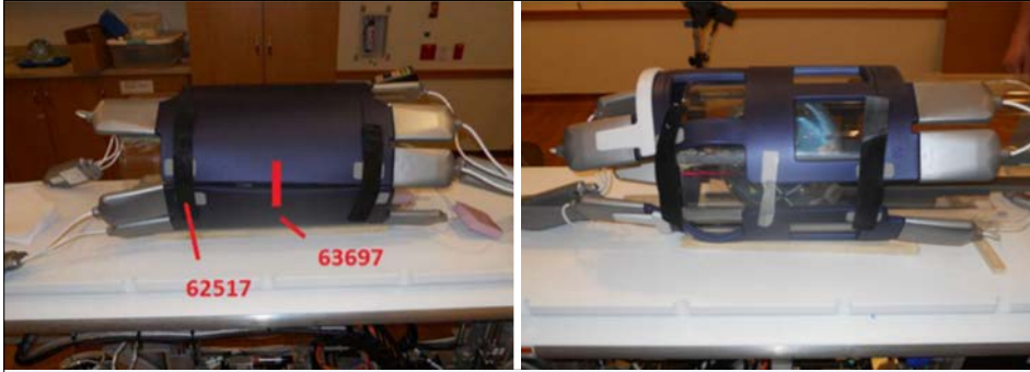
Şekil 2. Gövde ve Baş-boyun koili ile test setupü.
