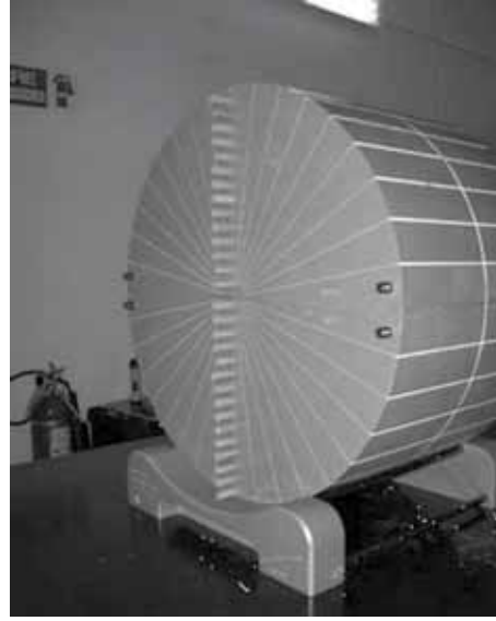
Şekil.2. MVCT performansı ve hasta kalite kontrolünde kullanılan Cheese fantom
